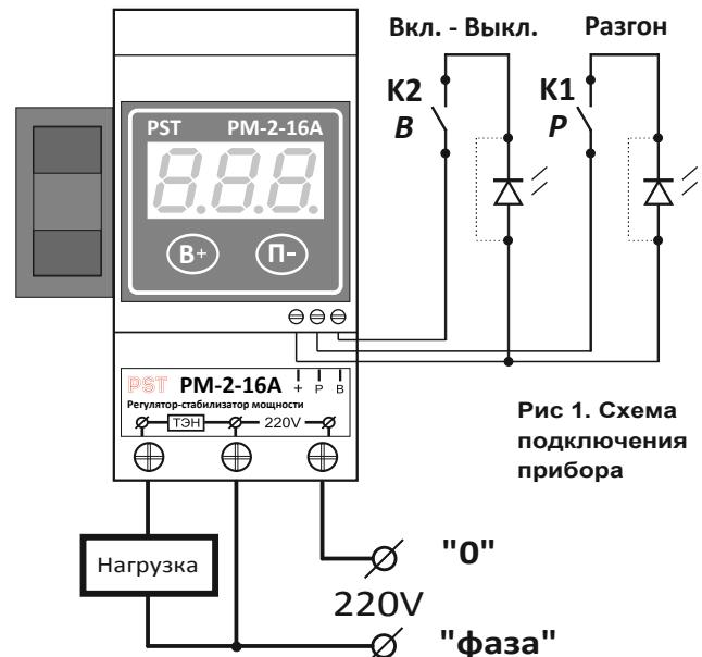
могут быть выключатель, тумблер, кнопка, автомат или свободные ("сухие") контакты терморегулятора. На клеммах **K1** и **K2** присутствует собственное управляющее постоянное (DC) низкое напряжение порядка 1,3 вольт, достаточно для включения подсветки внешнего или встроенного в кнопку светодиода с питанием 3 В. **Запрещается** подавать на контакты - «+», «Р», «В» какое-либо **дополнительное** питающее напряжение!
